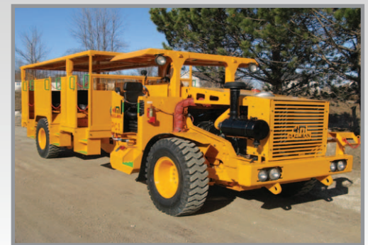
Camion de transport de personnel
